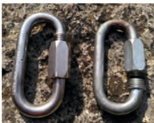
Links ein Edelstahl-Maillon, rechts ein verzinktes Modell, an dem deutlich Korrosionsspuren zu sehen sind. Das Schraubgewinde ist (noch) unversehrt.
